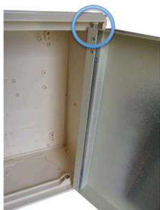
La porte aluminium de remplacement pour coffrets S300 ou C2300 sera posée si un élément interne remplacé ne permet plus de fermer la porte (compteur PR, détendeur ...). Si un remplacement de porte est envisagé, dans ce cas, il faut impérativement que les fixations de porte du coffret ne soient pas endommagées. Les portes sont réalisées selon la MCOF-307
