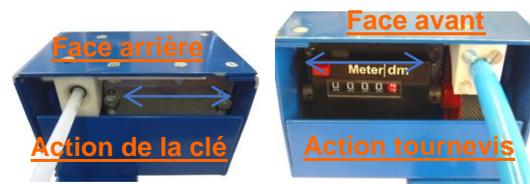
Dans le cas d'une avance non régulière ou inexistante cela peut-être du a un manque d'appuis de la roue sur le jonc. Il est possible de reprendre l'appui nécessaire en agissant sur les fixations du compteur.
